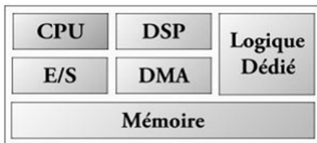
Figure 1.2 : schéma typique d'un Soc [8]
