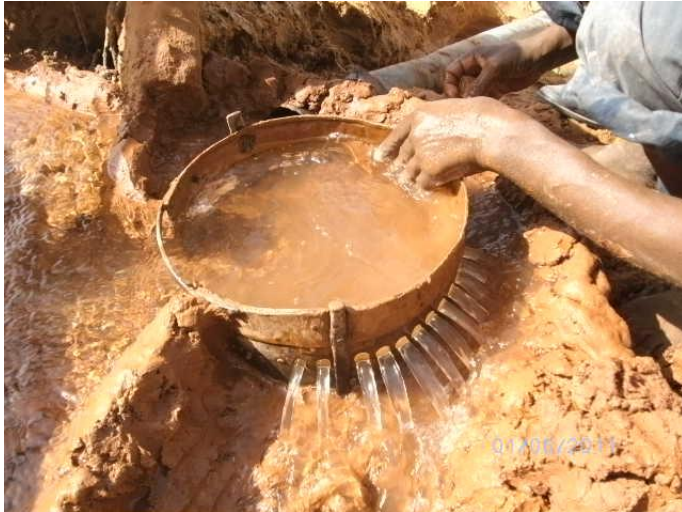
Fig. 1.19. Opération de mesure du débit dans les oasis de Tidikelt (photo Salah Hebi)
