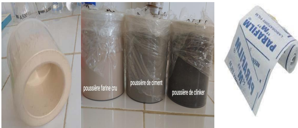
Figure 4. 1 : Forme Marinelli des conteneurs des échantillons et le ruban de paraffine
