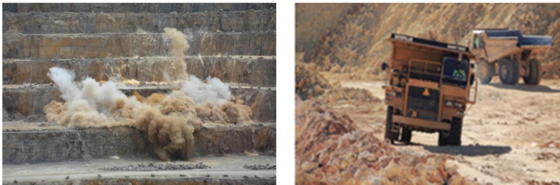
Figure 1.4 : Abattage et transport de calcaires.
