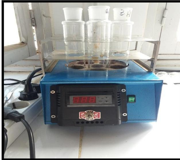
**Figure 2.3.** DCO mètre (bloc chauffant)
