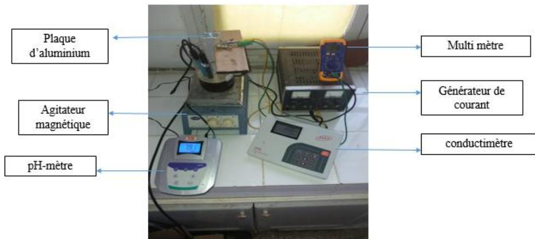
**Figure 2.1.** Dispositif expérimental d'électrocoagulation
