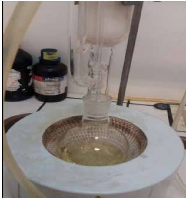
Figure 2.4 : Appareil Soxhlet au cours de délipidation (Photo originale 2018)
