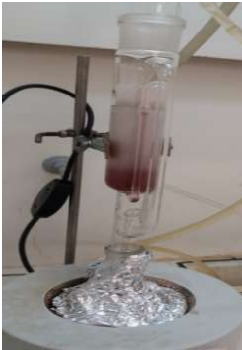
Figure 2.5 : Appareil Soxhlet au cours d'extraction des polyphénols, à gauche début d'extraction et à droite fin de l'extraction (Photo originale 2018)
