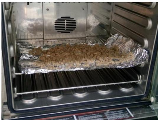
**Figure 4.9 :** Chitine dans l'étuve après NaOH.
