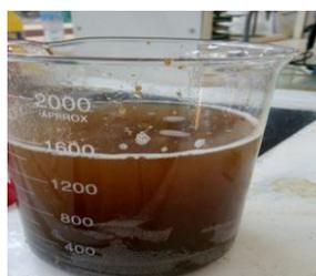
**Figure 4.5 :** Carapace dans solution de NaOH.
