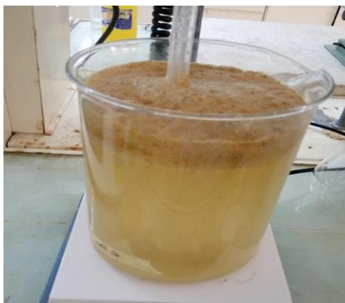
**Figure 4.4 :** Carapace dans la solution d'HCl.
