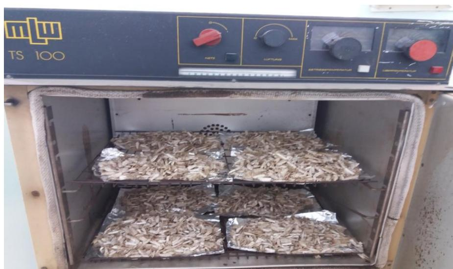
**Figure 4.1 :** Séchage de la carapace de crevette dans l'étuve.
