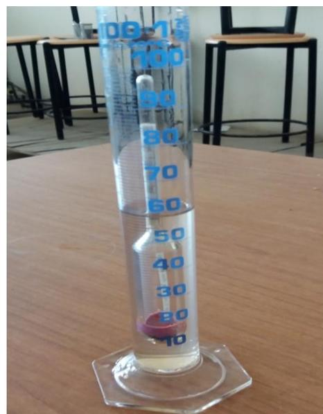
**Figure 4.11 :** Mesure de la densité.
