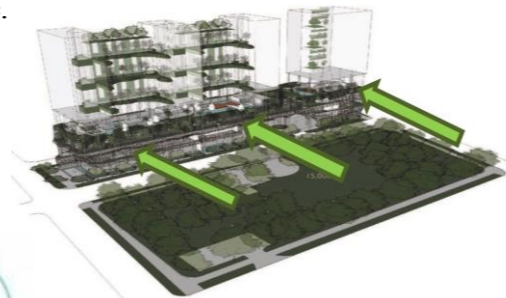
Figure 25 :Schéma représentela ventilation naturelles dans l'hôtel
