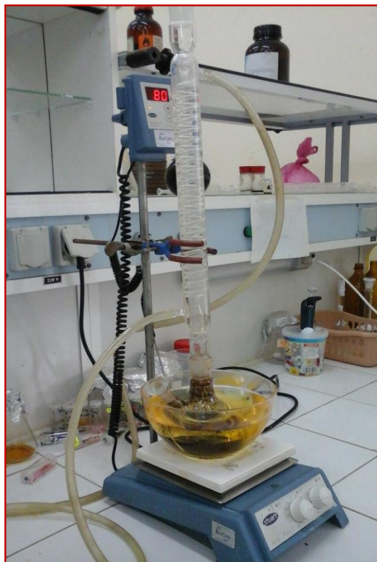
Figure II.2. Synthèse des nanotubes de carbone bi- parois/ nickel ferrite.
