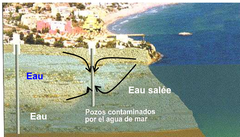
Figure I -5 : Forages contaminés par les eaux salées.[17]
