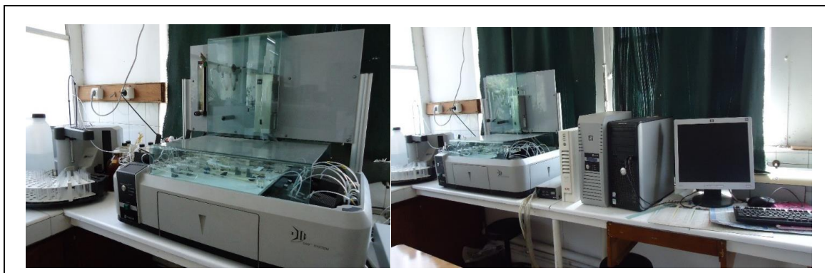
Photos 5 : Appareil pour détermination des chlorures
