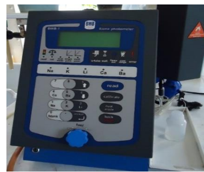
Photos 6 : Appareil de détermination du Ca, Mg, Na et K
