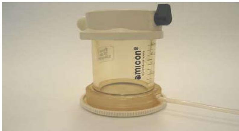
Figure (V.2): Cellule Amicon de filtration frontale (Amicon-Millipore)
