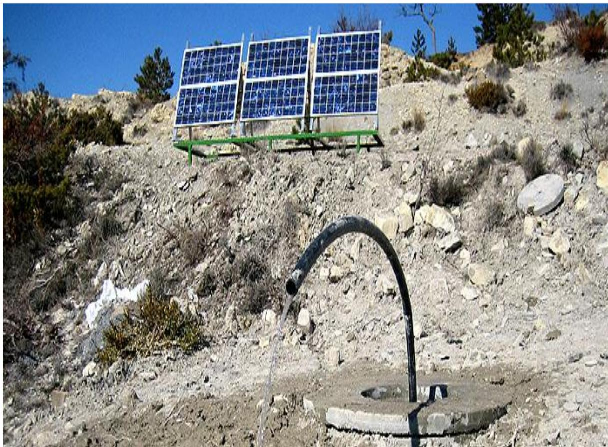
*Fig.3.21. pompe écologique utilisant l'énergie solaire*
