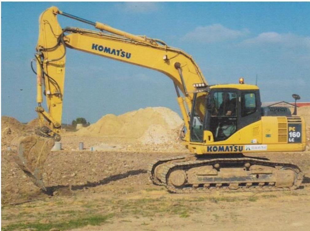
*Fig.3.15. pelle mécanique hydraulique à godet*
