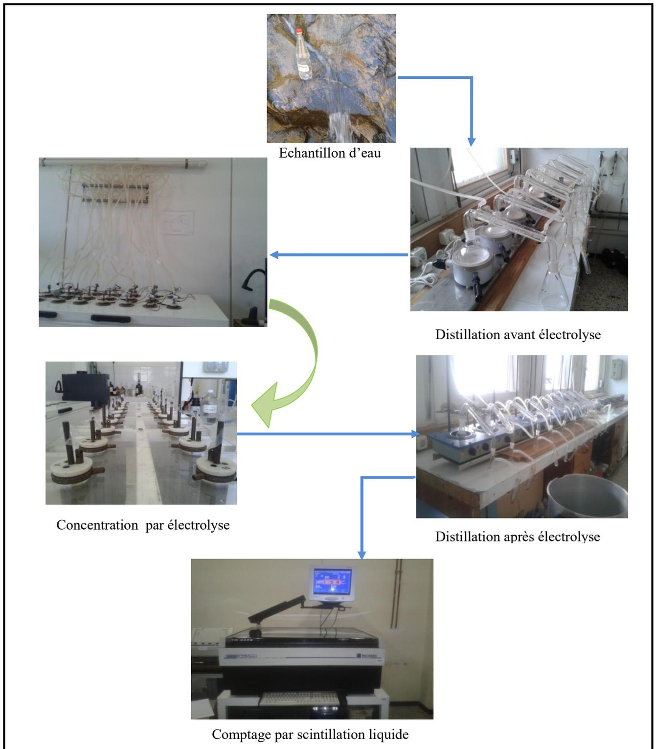
Figure II.9 : Technique de dosage du tritium par enrichissement électrolytique
