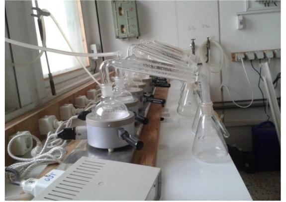
Système de distillation à clos
