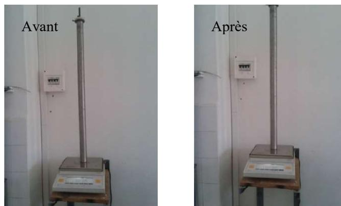
Figure II.10: Pesage des électrodes avant et après remplissage (CRNA 2013)
