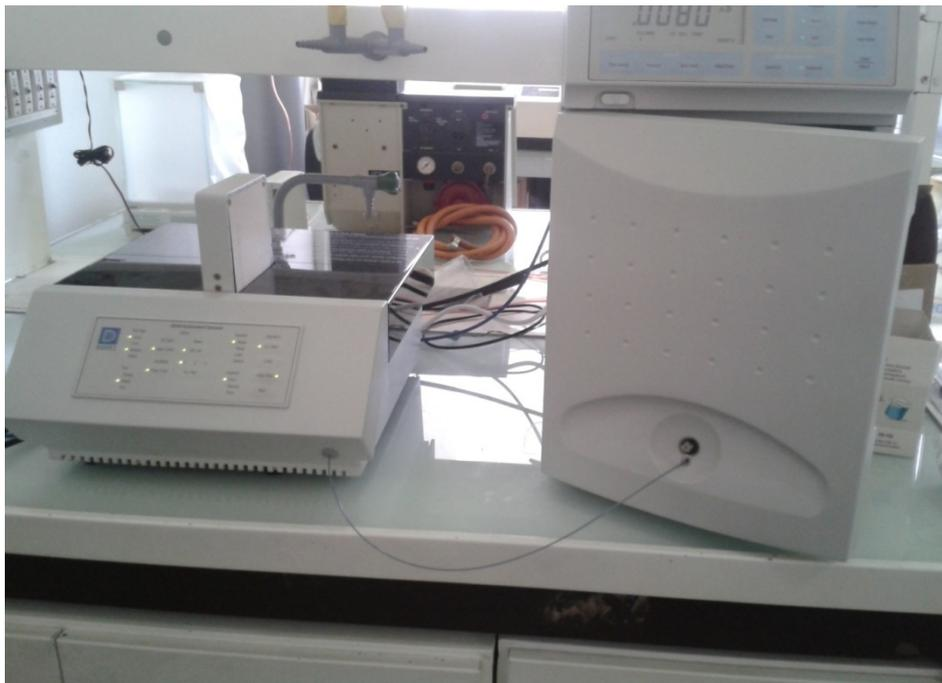
Figure II.6 : Chromatographe ionique DIONEX 120 (CRNA, 2013)
