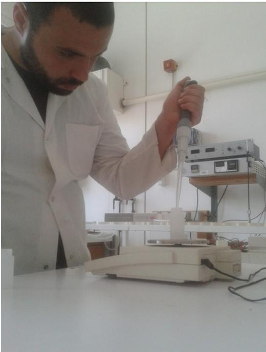
Figure II.12 : Préparation de 10ml d'échantillon avec scintillation pour préparé le comptage
