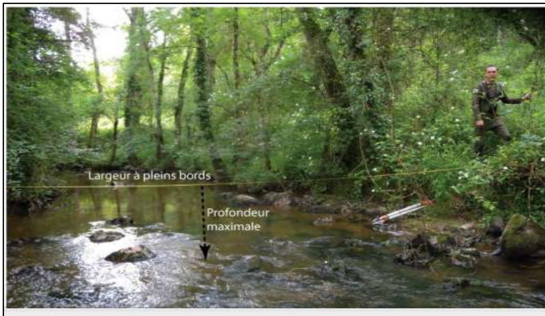
Photo N° 2-2 : Détermination de la largeur et de la profondeur à pleins bords (AURAH-CE, Valette et al, 2013)
