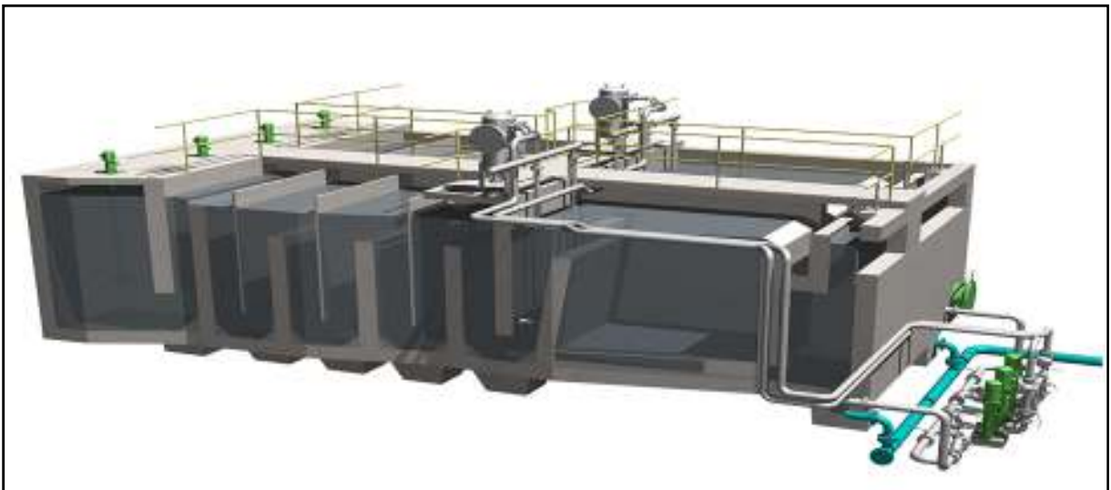
Figure V.12: Clarification des eaux de mer par flottation rapide, technologie «Seadaf» [46]
