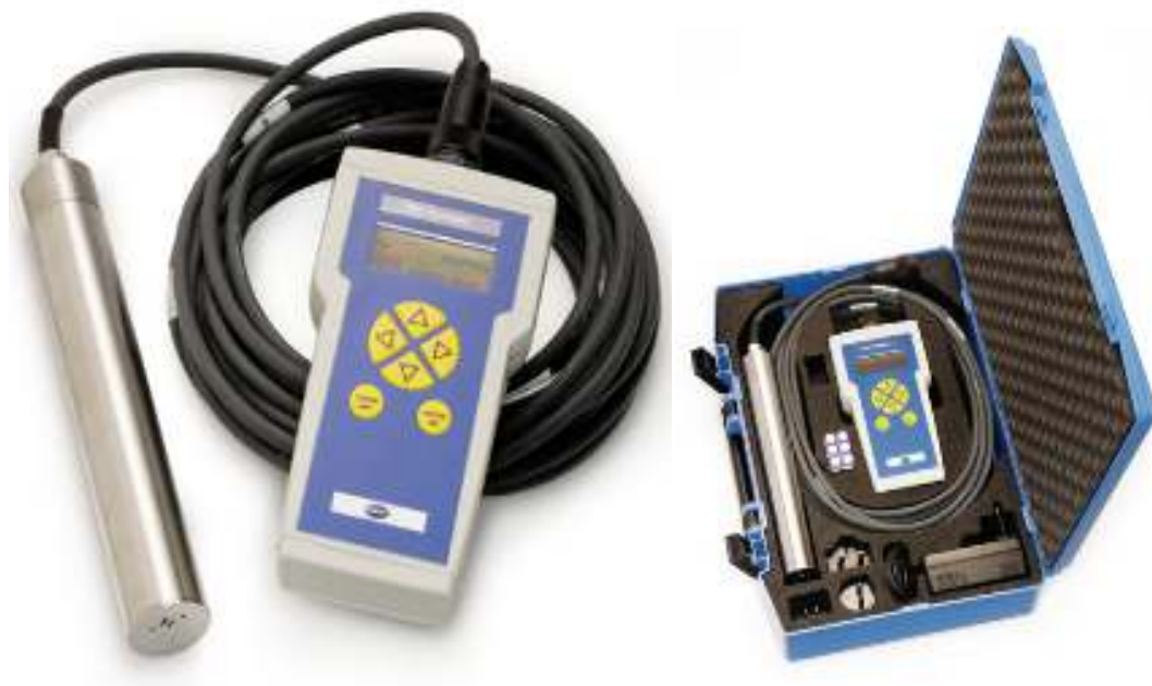
Figure V.8: Instrument portatif TSS pour la turbidité/les matières en suspension, la marque HACH [45]
