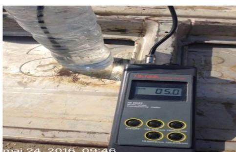
**Fig 4.24 :** mesure de la conductivité sur un forage à 100m de PZ B
