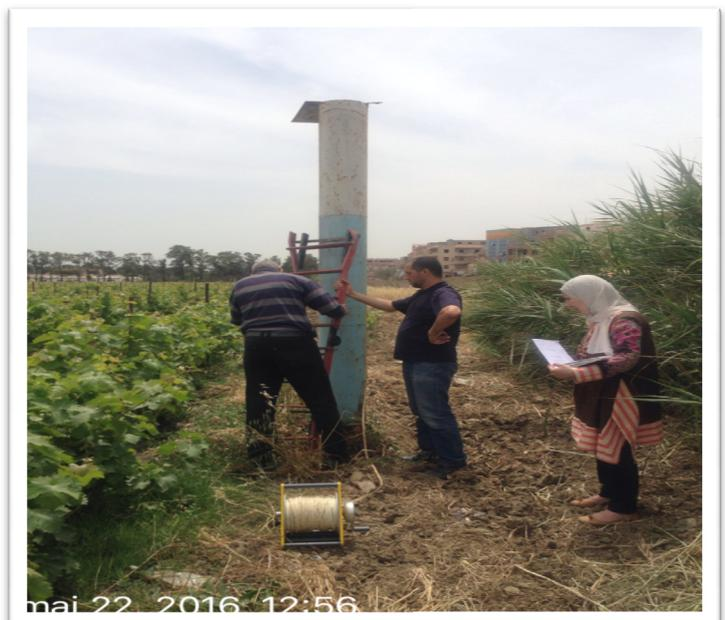
**Fig 3.7** : les mesures du niveau statique sur les piézomètres au niveau de la Baie d'Alger
