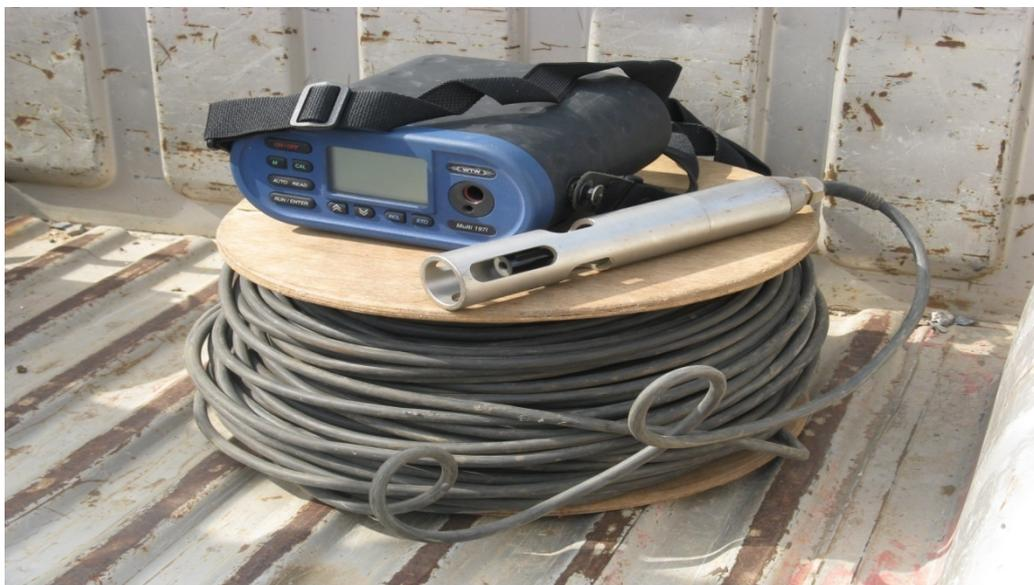
**Fig 3.2** : Conductivimètre portable
