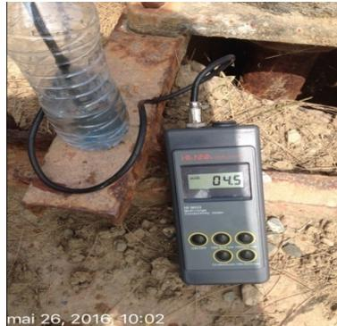
**Fig 4.25:** mesure de la conductivité sur un forage à 100m de PZ G
