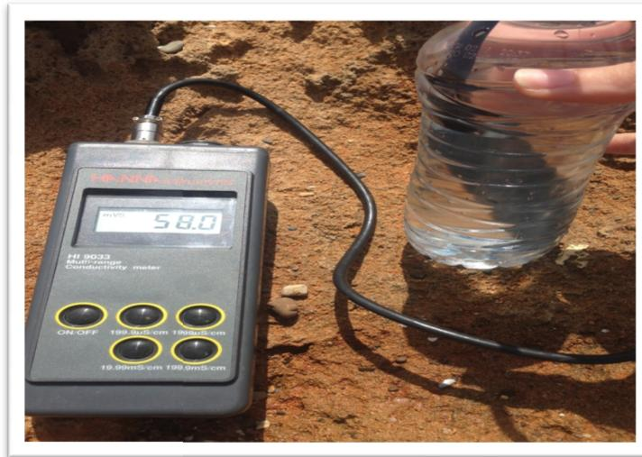
**Fig 3.6** : conductivimètre utilisé pour les mesures de la conductivité
