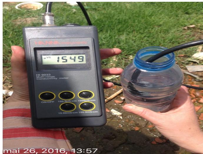
**Fig 4.26 :** mesure de la conductivité sur un forage à 400m de PZ E
