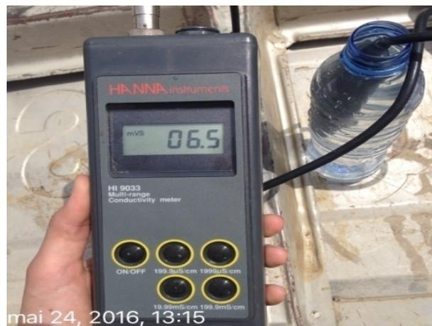
**Fig 4.28** : mesure de la conductivité sur un forage à 500m de PZ 45
