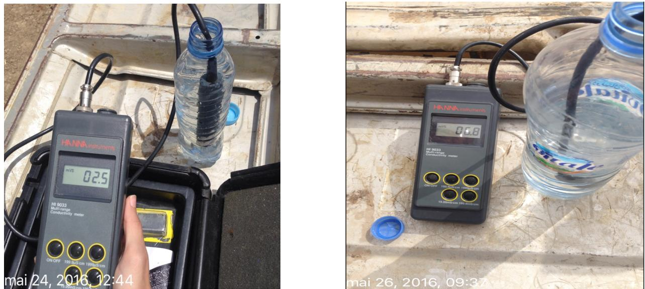
**Fig 4.29** : mesure de la conductivité sur un forage à 100m de PZ 50
