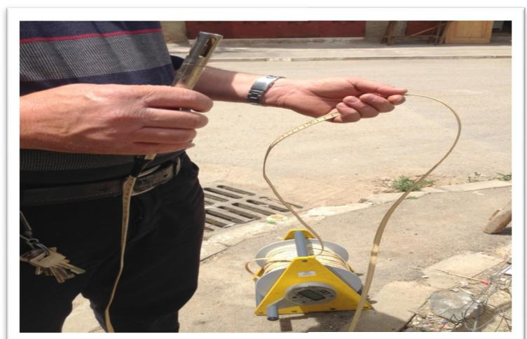
**Fig 3.4:** la sonde électrique utilisée pour la mesure du niveau statique
