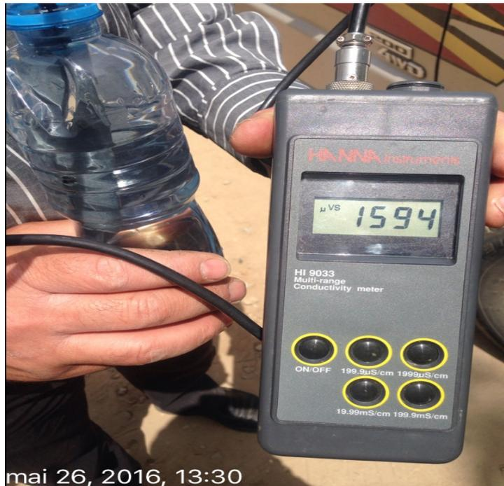
**Fig 4.27** : mesure de la conductivité sur un forage à 500m de PZ 41
