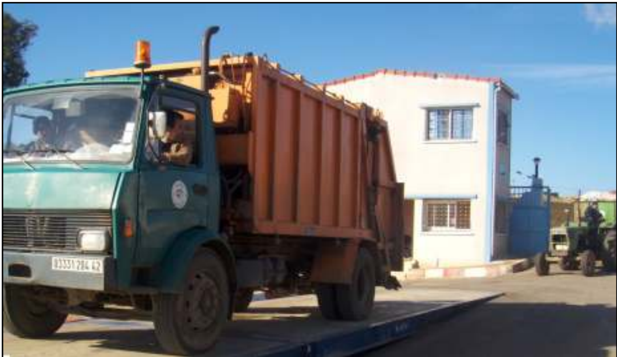
Photo 09 : Contrôle et pesé des déchets acheminé au CET
