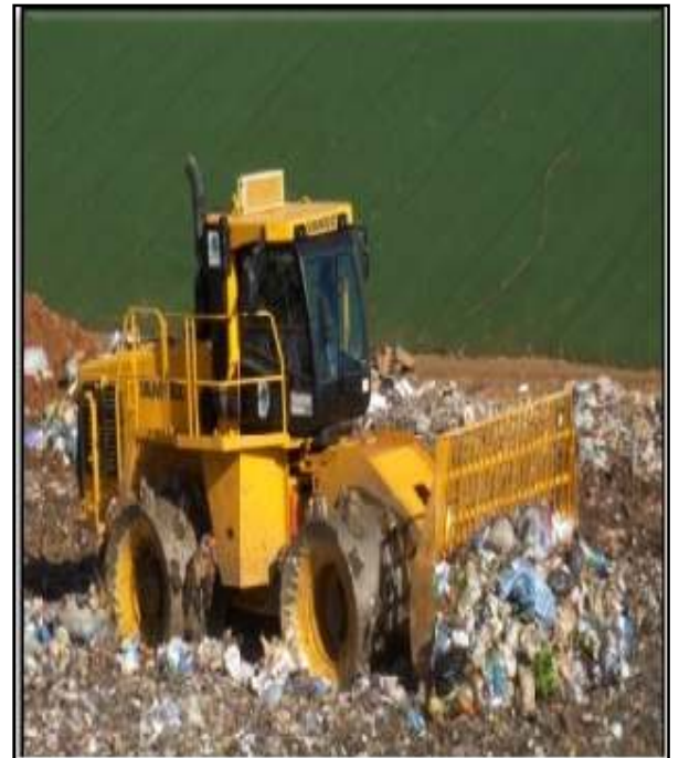
Photo14 : déchargement des déchets au niveau photo14: Etalage et compactage des Du casier déchets
