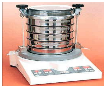
Figure II.10 : Photo de Tamiseuse à vibrations utilisé.
