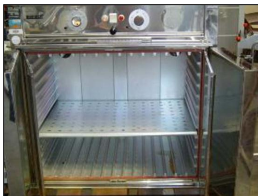
Figure II.4 : Photo de Sécheur en Etuve ventilée utilisé.
