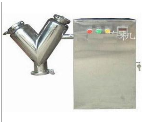
Figure II.6 : Photo de mélangeur à tambour en V utilisé.
