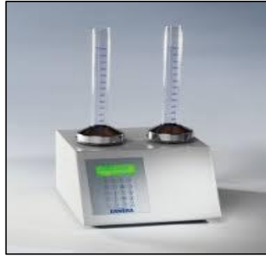
Figure II.9 : Photo Appareil de l'aptitude au tassement utilisé.
