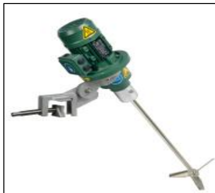
Figure II.2: Photo d'agitateur à hélice NETTCO Série I utilisé.
