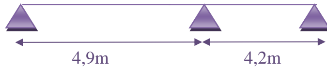
Fig.III.13: poutrelle à 2 travées
