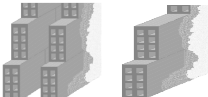
Fig. II.2. Mur simple et double cloison.
