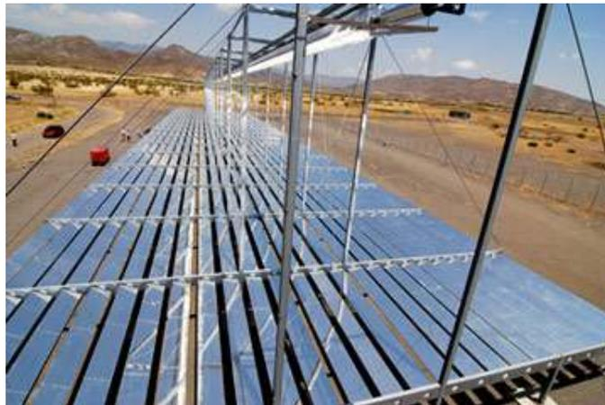
**Figure 3.2:** Capteur solaire avec effet de concentration avec miroirs de Fresnel.
