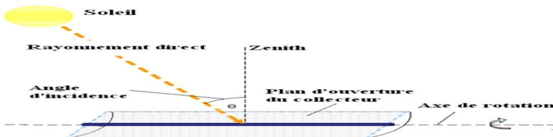
Figure 1.16. L'angle d'incidence sur un concentrateur solaire Cylindro-parabolique
