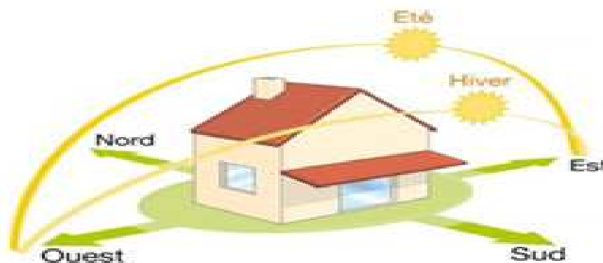
Figure 1.1. Orientation et implantation d'une maison
