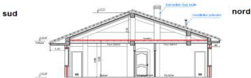
Figure 3.2 : Coupe de la toiture avec appartement R+4
