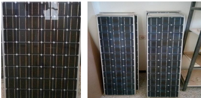
Figure IV.13 : décolorées de Module photovoltaïque Isofoton-100-et UDTS-50-
