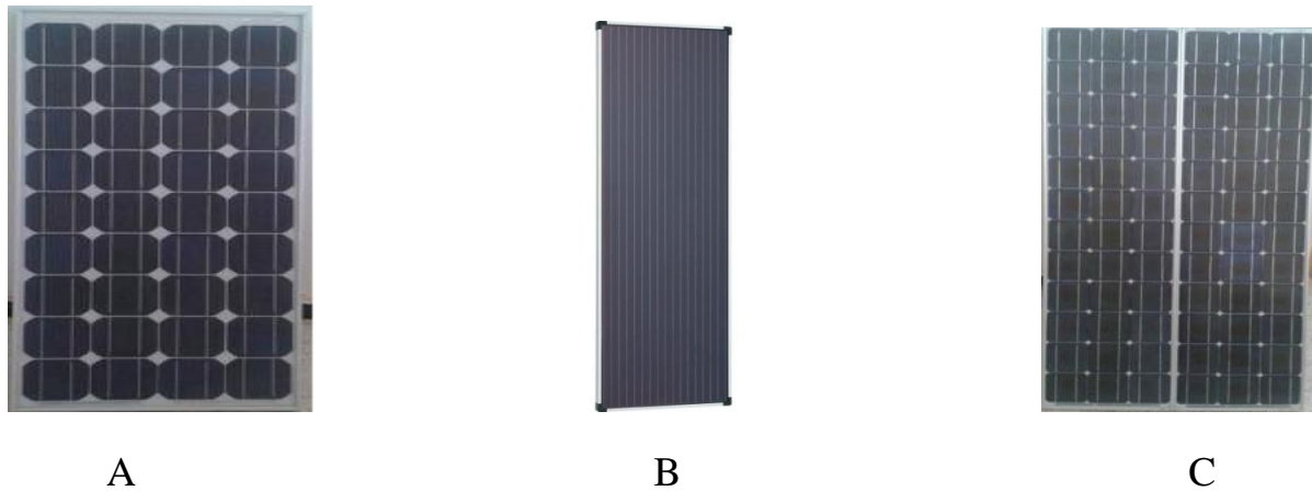
Figure IV.2 : module photovoltaïque sous test (A) isofoton (B) amorphe (C) UDTS
