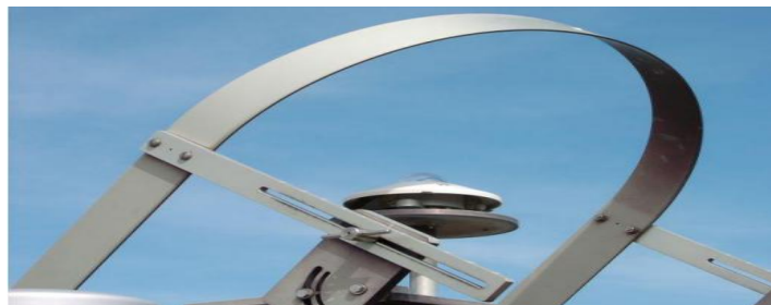
Figure I.4 l'instrument qui mesure le rayonnement diffus [9]
