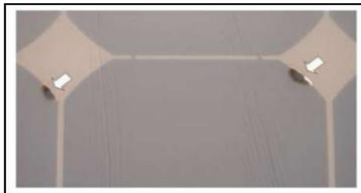
Figure III.7 Modules présentant des points chauds sur les bords des coins supérieurs. [48]
