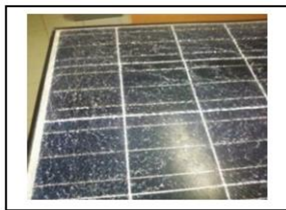
Figure III.6 Module photovoltaïque présentant des bris de verre. [30]
