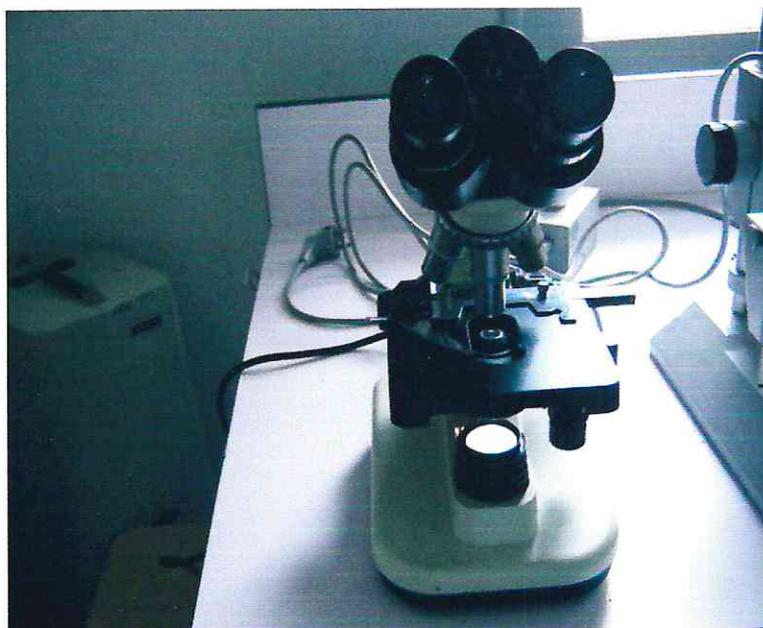
**Photo 27 :** Microscope photonique à image non inversée à objectifs 4, 10,40 et 100 et une huile à immersion
