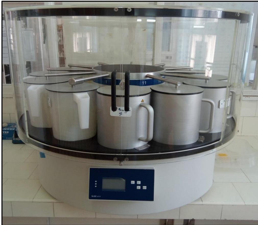
Figure 21 : L'automate de déshydratation et d'éclaircissement
