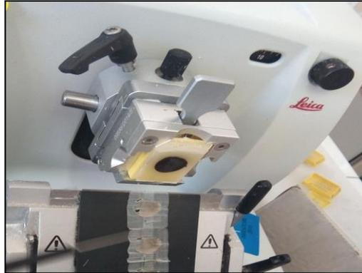
Figure 35 : Coupe des blocs au microtome
