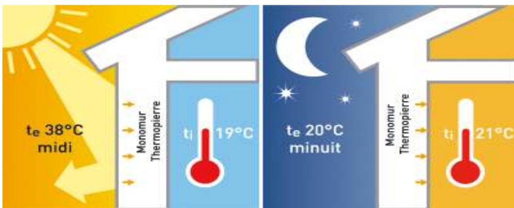
Figure 1.14 : capacité de l'inertie thermique des mur
