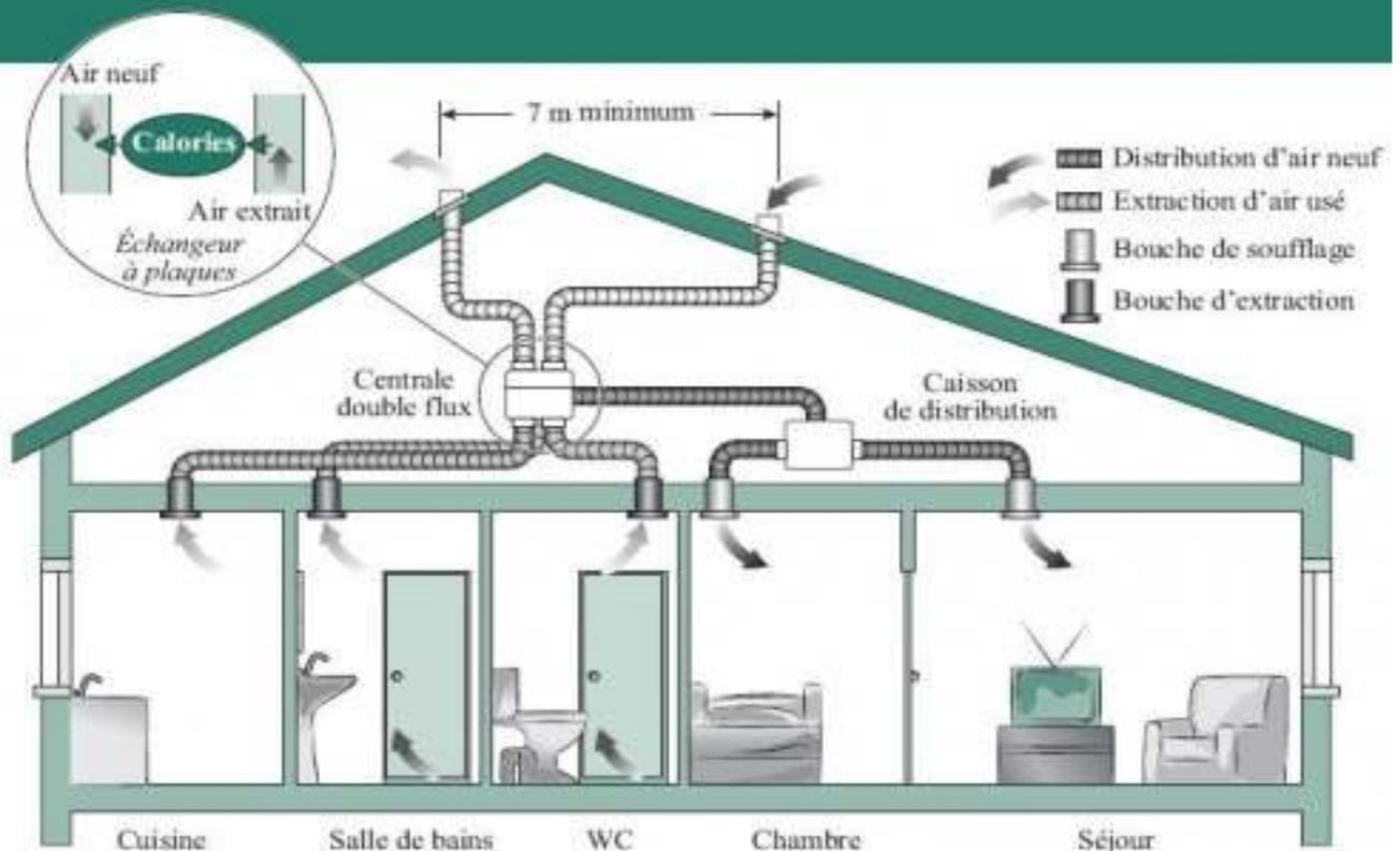
Figure 1.11 : principe de la ventilation mécanique contrôlée [19]
