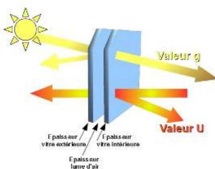
Figure 1.12 : les facteurs énergétiques d'un double vitrage
