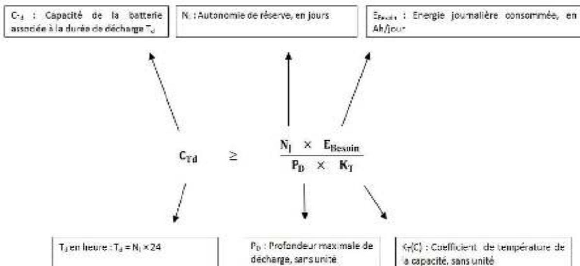
Figure 4-17 : calcul de capacité des batteries
