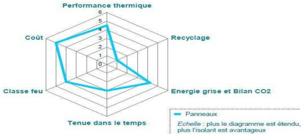
Figure 4-2: performance thermique de polystyrène expansé
