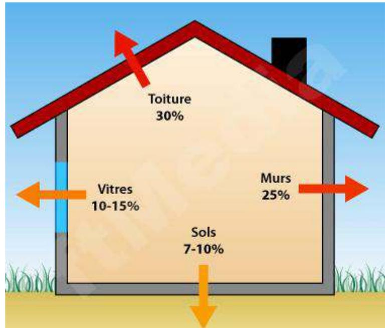
Figure 1.15 : déperditions thermiques dans le bâtiments[20]
