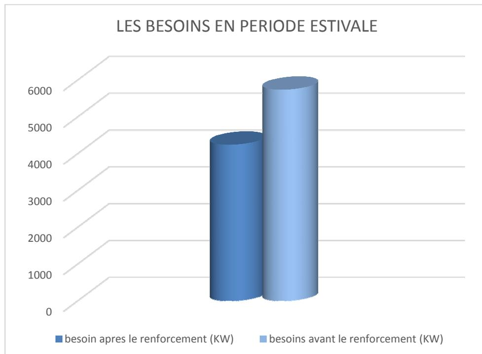
**Figure 4-4 :** histogramme de comparaison entre les besoins avant et après le renforcement
