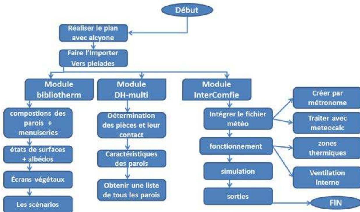
Figure 3.2 : Procédures d'injection des données sur PLÉIADES
