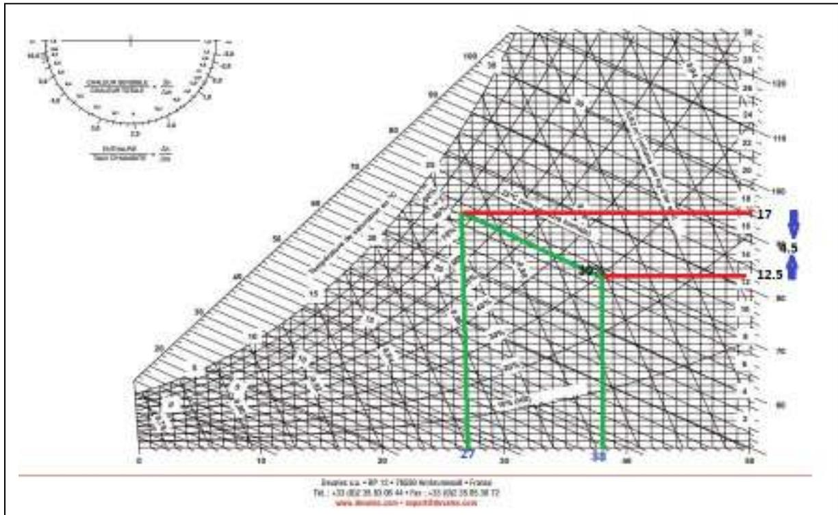
Figure 4.15 : rafraîchissement par humidification « diagramme psychométrique »
