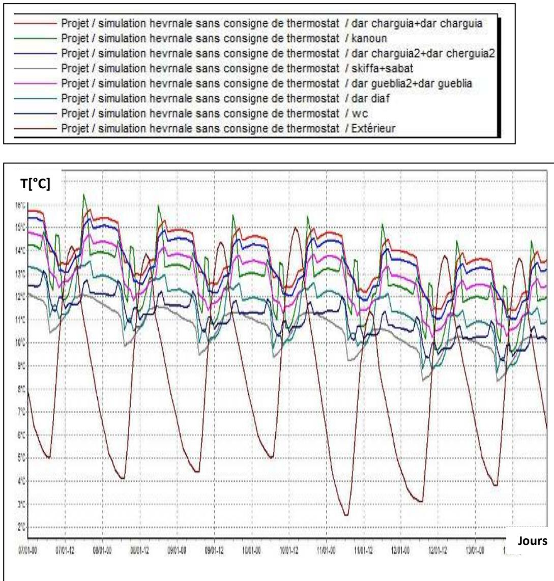
**Figure 4.8: Evolution de température en hiver pendant la semaine la plus froide simulation n° :03**
