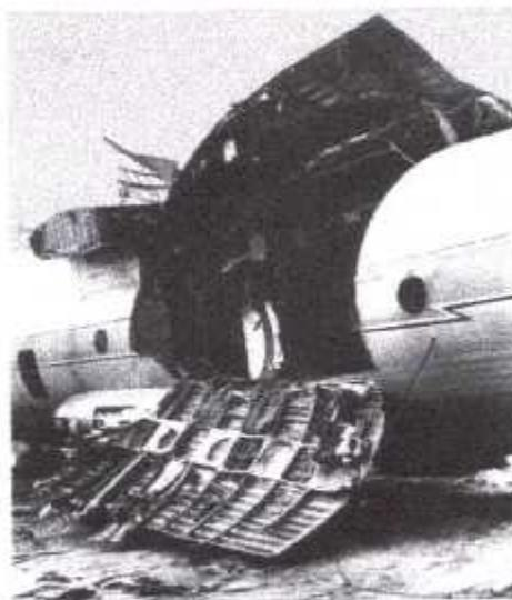
**Figure I-6 :** Photo de la rupture d'un panneau après propagation critique de plusieurs fissures
