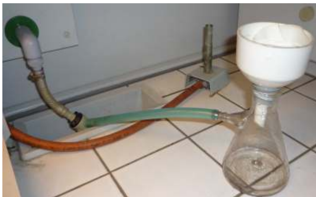
Figure ( annexe -2) : Dispositif de filtration sous vide
