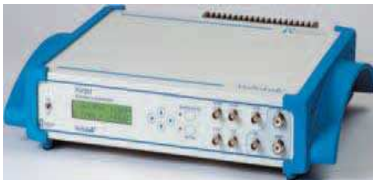
Figure III.4. Image photographique du potentiostat/Galvanostat voltalab21 , utilisé.
