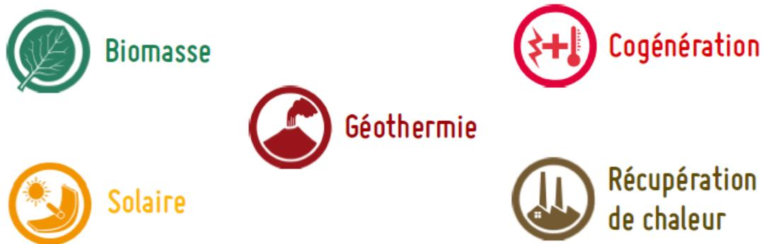
Figure I. 14: Domaines d'application des ORC [25].
