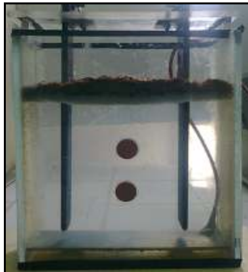
Figure 4.11 : Solution clarifiée après traitement d'EC/EF
