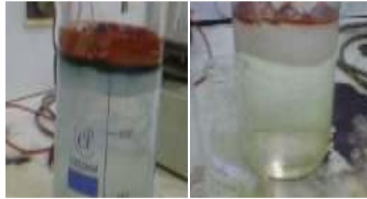
Electrodes en Fe      Electrodes en Al
