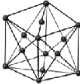
Fig. I.1 : La forme cristalline de l'Aluminium CFC
