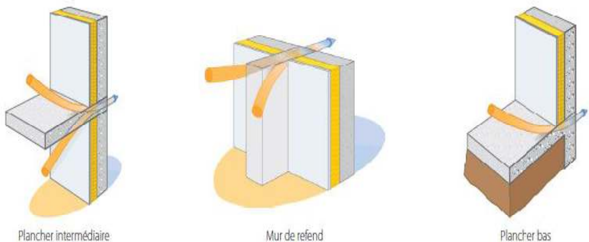
Figure 1. 8 : Les ponts thermiques de liaison structurels
