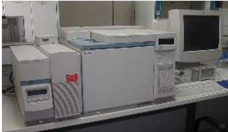
**Figure 22 :** Couplage : chromatographe-spectromètre de masse.
