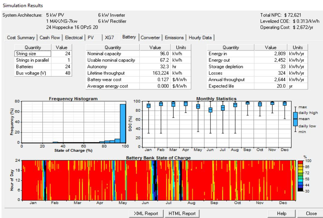
Figure A.25. Etat de charge/décharge des batteries.
