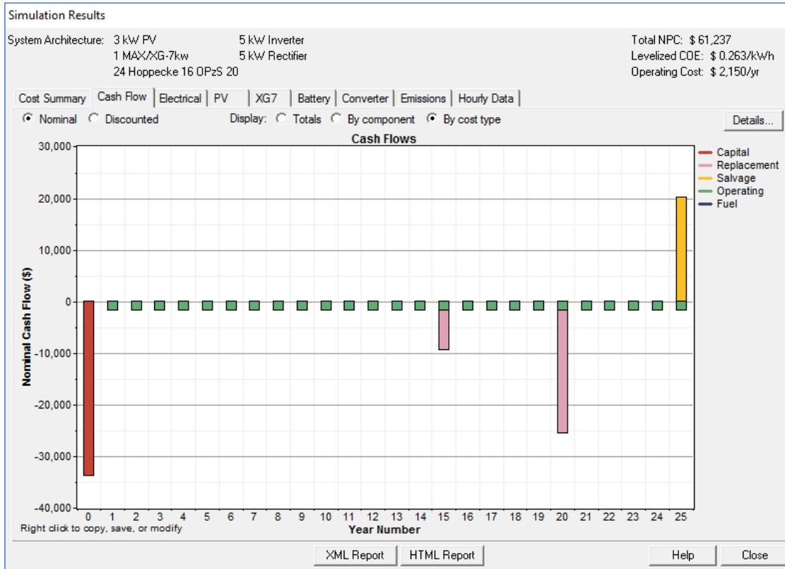
Figure A.30. Fenêtre des différents coûts du système durant sa durée de vie.
