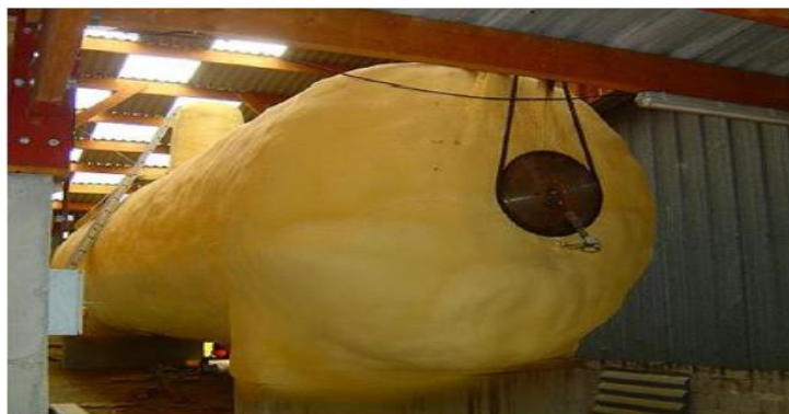
Figure I.9 : Un digesteur par voie pâteuse.
