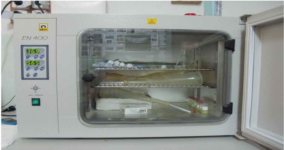
Figure n°7 : Etuve utilisé pour l'incubation des solutions préparés
