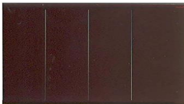
Figure 1.27 Cellule du silicium amorphe en couche mince. [46]
