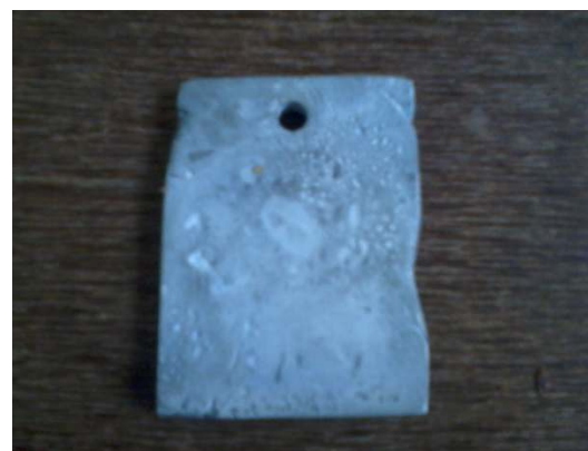
Figure IV-6 : Anode de Zn
