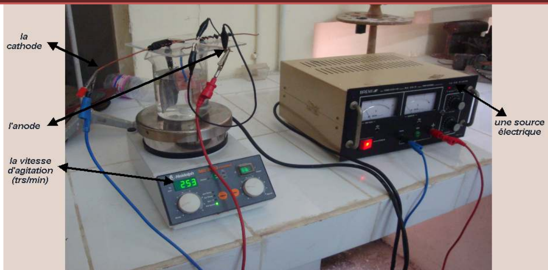
Figure IV-2 : Montage expérimental de l'électrodéposition
