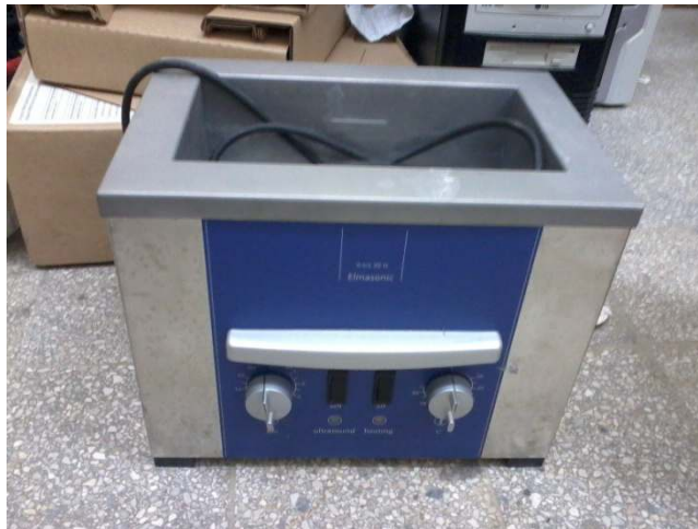
Figure IV-3 : Cuve à ultrason utilisé pour l'agitation des particules Al 2 O 3
