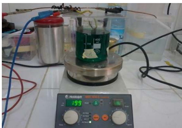
Figure IV-9 : Revêtement de Ni-pur
