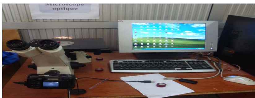
Figure IV-14 : Microscope optique utilisé pour l'analyse métallographique
