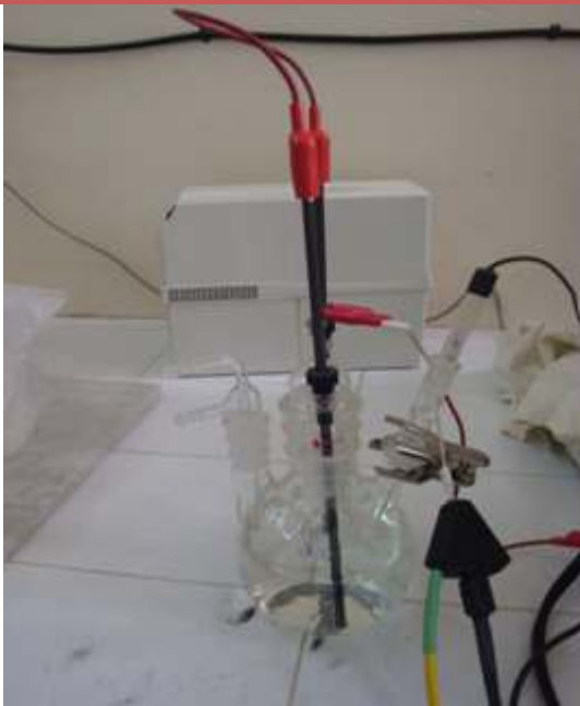
Figure IV-16 : Cellule de corrosion
