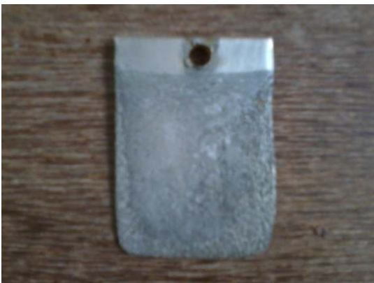
Figure IV-5 : Anode de Ni
