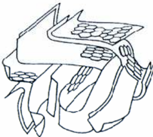
Figure II.1 Représentation schématique des microstructures du charbon actif
