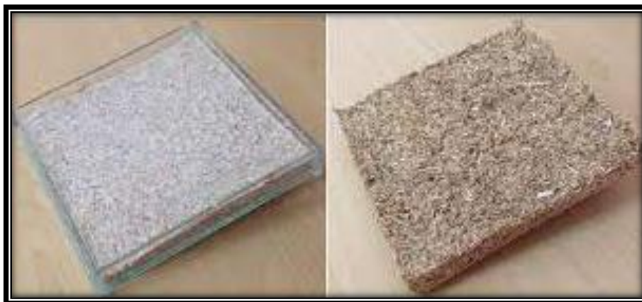
Figure III. 56: Isolant à base de fibre de palmier ; Source : B. Agoudjil, A. B. (2015). Nouveaux matériaux biosourcés à base de bois de palmier dattier pour l'isolation thermique dans l'habitat. Récupéré sur https://hal-enpc.archives-ouvertes.fr/hal-01262013/file/Boudenne.pdf
