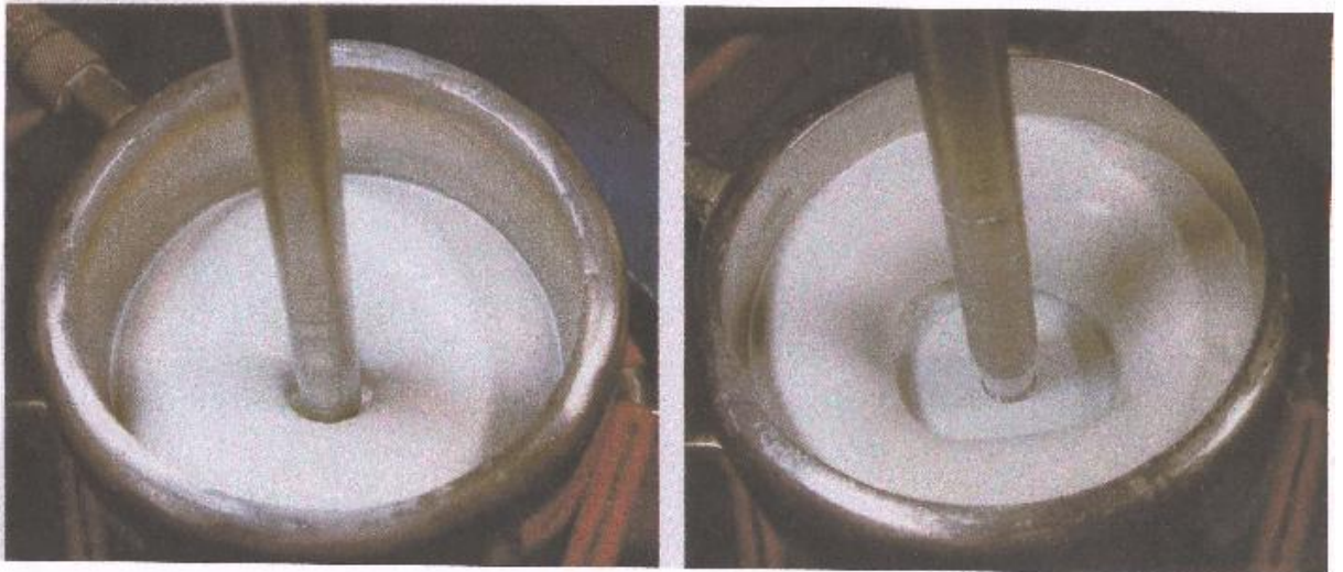
Figure (3.6) Comportement optimal à l'écoulement est comportement impropre à l'écoulement.
