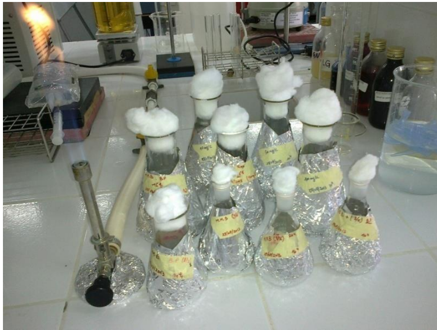
Figure III.8: Essais d'acclimatation et biodégradation du phénol en Erlenmeyers.
