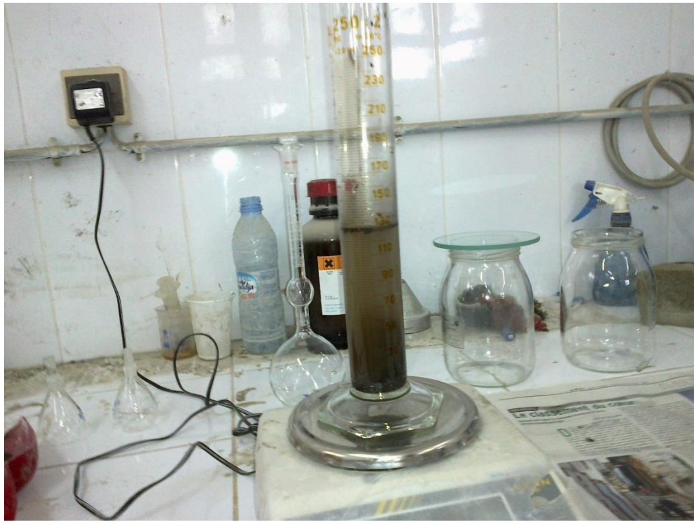
Figure III.6 : Essai de masse volumique absolue.
