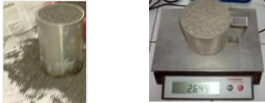
Figure III.5 : Essai de la masse volumique apparente.
