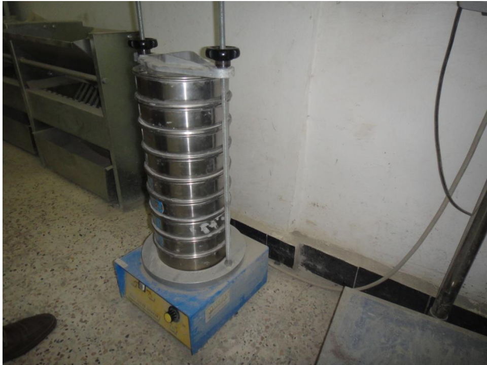
Figure III.4: Photo de la colonne de tamis.
