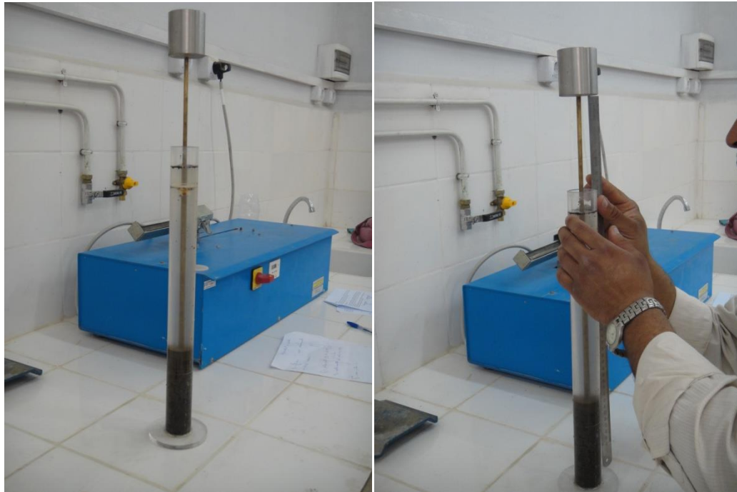
Figure III.7 : Essai d'équivalent de sable.
