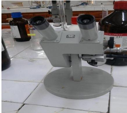
Figure 16: Réfractomètre Abbé.
