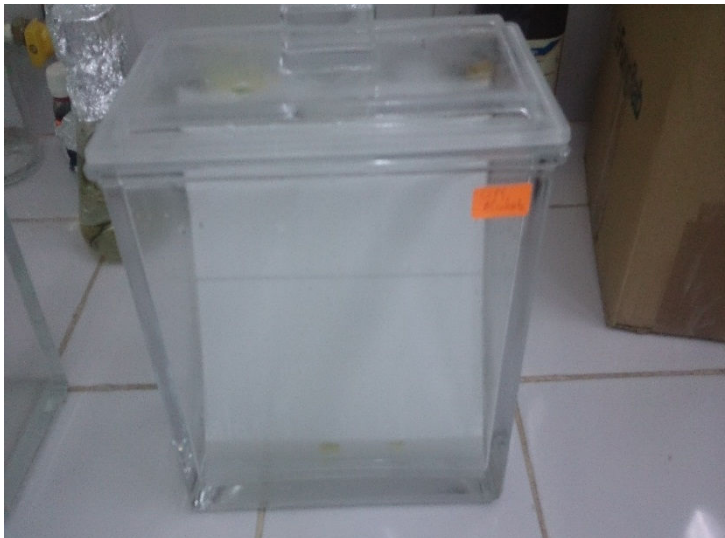
Figure 20 : Photo de Cuve de CCM
