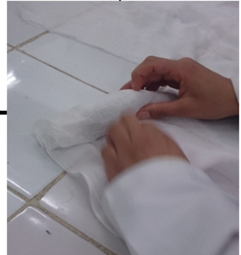
Placement de la poudre alcalinisée dans une cartouche en cellulose
