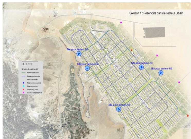
FIGURE III 24: SYSTEME D'ALIMENTATION EN EAU POTABLE SOURCE : EGIS 2012
