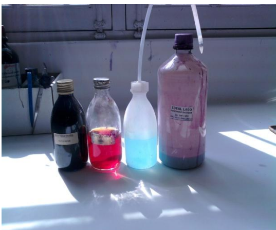
Les reactifs de la coloration de Gram (violet de gentiane,Lugol,alcool,Fushine)
