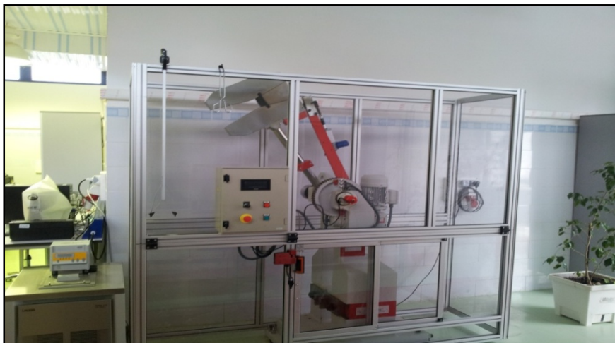
Figure III.6 : Mouton pendule ou mouton de Charpy
